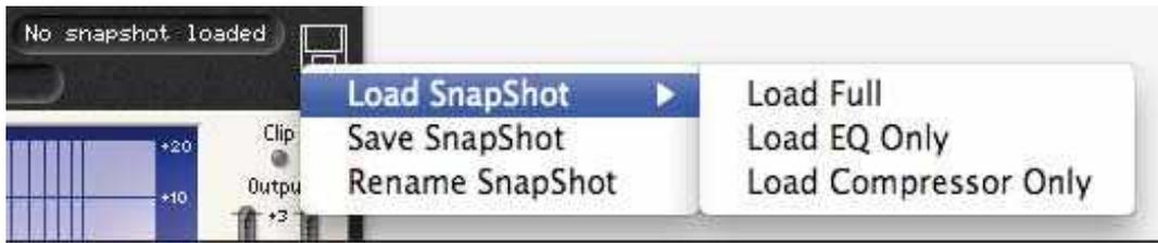
Um einen Snapshot zu laden, klicken Sie auf das Disketten-Symbol und selektieren Sie 'Load Snapshot' aus der Drop-Down-Liste. Mit 'Load Snapshot' können Sie den kompletten Snapshot (Kompressor und EQ) laden, mit 'Compressor Only' nur den Kompressor (Ihre derzeitigen EQ-Einstellungen bleiben bestehen), oder mit 'EQ only' entsprechend nur den EQ (Ihre derzeitigen Kompressor-Einstellungen bleiben bestehen).
