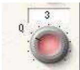
Der Q-Regler bestimmt die Bandbreite der Frequenz dieses Bandes. Der Regler arbeitet invers, das Erhöhen des Wertes führt zu einer Verkleinerung der Bandbreite. Ein hoher Q-Wert führt zu einem fokussierten, engen Band um die eingestellte Frequenz. Ein niedriger Q-Wert hat einen ausgedehnteren Effekt über einen größeren Frequenzbereich.
