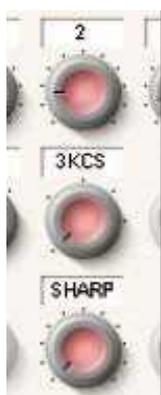
Um ein Band zu selektieren, drücken Sie auf einen der Regler – alle Regler des Bandes erscheinen nun in rot. Der EQ-Typ wird jetzt im 'Active'-Feld angezeigt, die Emulation, aus der das Band stammt, wird im 'EQ'-Feld angezeigt.
