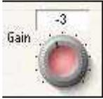
Der Gain-Regler verstärkt oder senkt den Pegel des entsprechenden Bandes. Die Werte und Bereiche jeder EQ-Emulation entsprechen denen des originalen EQs. Beachten Sie, dass für einige Typen von Bändern, beispielsweise High-Pass und Low-Pass, der Gain-Regler nicht aktiv sein wird, da für solche Typen nur die Frequenz und manchmal Flanke zur Verfügung steht.
