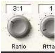
Der Ratio-Regler bestimmt wie stark der Kompressor das bearbeitete Signal komprimiert, und ist die Ratio / das Verhältnis der Änderung des Eingangssignals verglichen zum bearbeiteten Ausgangssignal.
