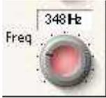
Der Frequenz-Regler bestimmt den Bereich des Frequenzspektrums, das dieses Band beeinflusst. Für einige Typen, wie zum Beispiel 3 kHz Peak/Notch, wird der Frequenz-Regler nicht aktiv sein, da der Wert festgelegt ist.
