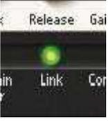
Diese Funktion ermöglicht den linken und rechten Kanal in gleichem Maße zu komprimieren, dies wird durch das Zusammenlegen der Sidechain-Signale erreicht (siehe Hinweise zu Sidechain weiter unten), sinnvoll für die Bearbeitung von Stereosignalen. Die aktive Link-Funktion ist beim Laden einer Stereo-Instanz des Liquid Mix die Standard-Einstellung.
