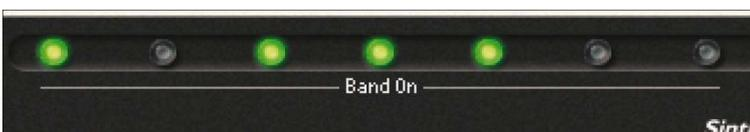
Drücken des Band On Schalters aktiviert das entsprechende Band. Für jedes Band gibt es einen Band On Schalter, je unter dem entsprechenden Gain, Frequenz und Q Regler des Bandes.
