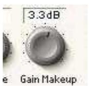
Komprimieren eines Signals führt zu einer Absenkung der maximalen Lautstärke. Die Gain Makeup Funktion ermöglicht Ihnen, den Signalpegel wieder anzuheben. Die Werte der verfügbaren Einstellungen ist abhängig vom gewählten Kompressor. Der genaue Wert wird in dB über dem Regler dargestellt.
