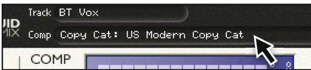
Die Kompressor-Emulation wird durch Klicken in diesen Bereich ausgewählt. Wählen Sie den gewünschten Kompressor aus der Auswahl der Drop-Down-Liste aus. Beachten Sie, dass eine neue Emulation mit Standardeinstellungen geladen wird, somit muss der Kompressor beim Wechseln der Emulation wieder individuell eingestellt werden. (Alternativ Snapshots verwenden – dazu später mehr.)
